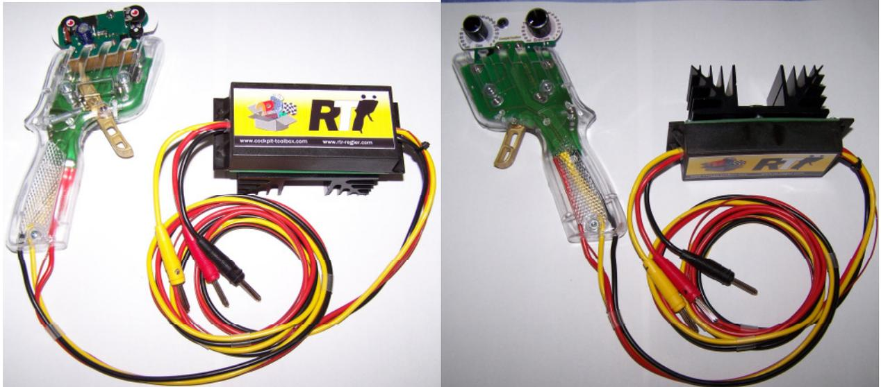
So sieht es dann fertig aus. An geeigneter Stelle wird das Kabel durch geschnitten (lieber paar cm Kabel mehr nehmen) oder um ca. 20-30 cm wird das Kabel verlängert und an der Platine angelötet. Ein Steuerkabel, hier das dünne rote Kabel (0,18mm<sup>2</sup>), vom [Ausgang auf der Platine zum Regler gezogen](#), siehe Bilder oben Seite 1. **In der 15A Ausführung muß der Transistor auf der RTR V7 Platine ausgelötet oder abgezwickt werden.**
